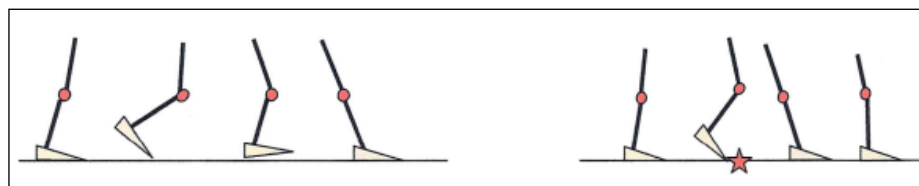
Abb. 5 Echelon: Bodenfreiheit während der Schwungphase. Abb. 6 Festeingestellter Knöchelgelenkfuß.
