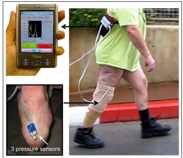
Abb. 10 a-c Mittels Messstreifen werden Belastungen und Spannungen im Stumpf gemessen.
